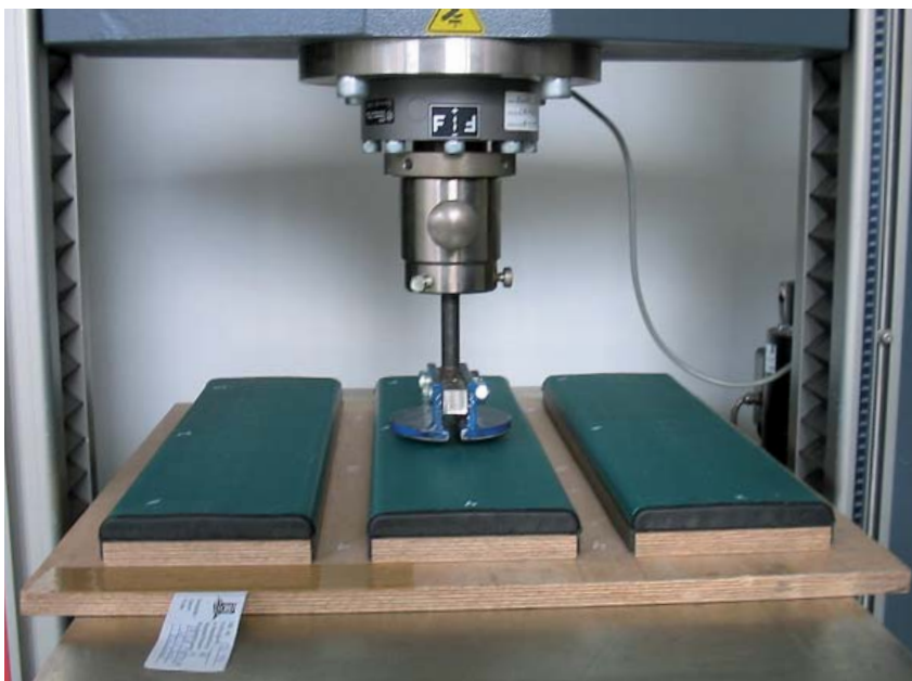
Bild 3: Messung der Verformbarkeit mit künstlichem Kuhfuß
