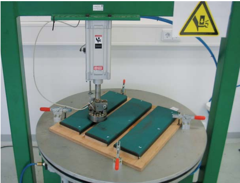
Bild 4: Prüfstand für Dauertrittbelastung
