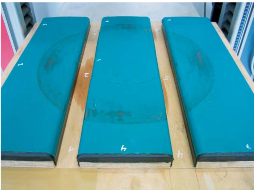
Bild 5: Bodenbelag nach der Dauertrittbelastung
