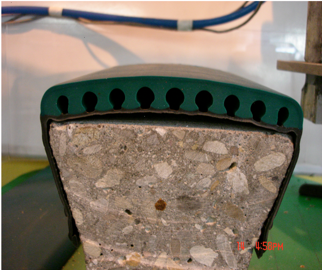
Bijlage 1: Foto van toepassing van aangebracht element op roostervloer
